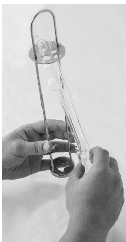
Abb. 5 Einführen bzw. Austauschen eines Viskosimeters mit Lichtschrankenabtastung
